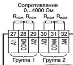
Рисунок 4.15 – Схема подключения резистивных датчиков
