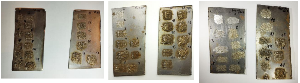
Рисунок 8 – Электроискровые покрытия полученные в зависимости от различной скорости вращения электрода и параметров электроискровой установки
