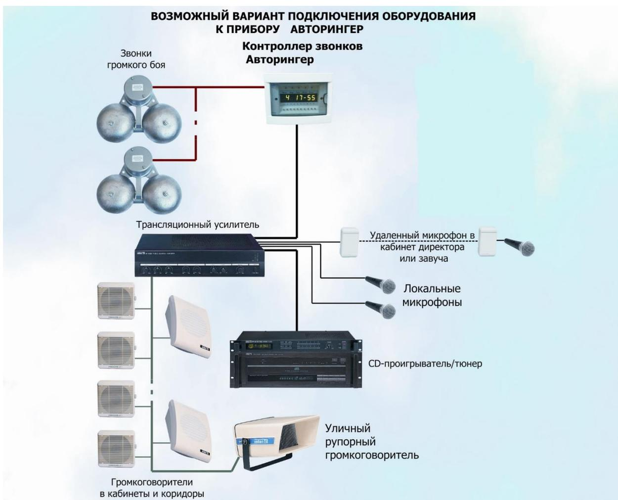
Рисунок 1- Схема подключения ИНФОЛАЙТ Авторингер-52СМ
