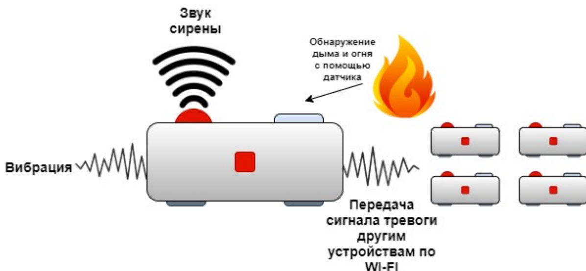
Рис.3 – Алгоритм передачи сигнала от одного сигнального противопожарного вибро-устройства для лиц с инвалидностью по слуху «Безопасный сон» на другие
