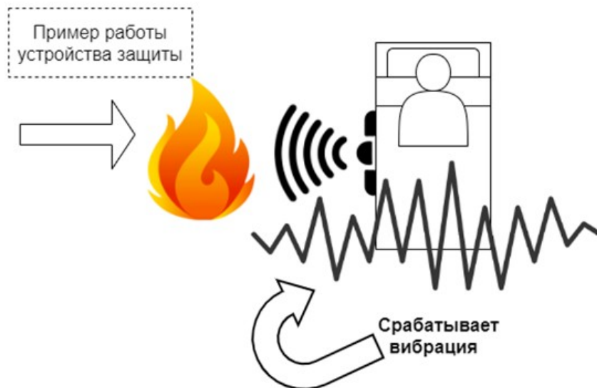
Рис.2 – Алгоритм работы сигнального противопожарного вибро-устройства для лиц с инвалидностью по слуху «Безопасный сон»
